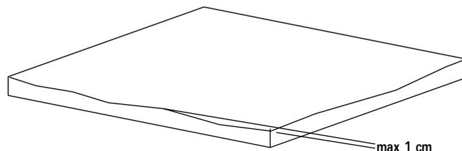
Pour éviter toute infiltration d'eau, la dalle de béton ne doit pas excéder les dimensions de l'abri. Si elle est plus grande, l'eau de pluie ruisselant du toit s'accumulera sur la dalle et s'infiltrera dans l'abri. Dans ce cas, nous déclinons toutes responsabilités en cas d'infiltration d'eau. La dalle ne doit pas avoir plus de 1 cm de défauts de planéité. Le produit doit être à 50cm au moins de tout mur, haie ou grillage afin de permettre son montage et son entretien.
